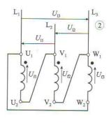
Sur la figure on voit que les tensions de phase et les tensions de ligne sont les mêmes mais les courants sont différents. Ils se divisent dans un noeud du triangle. De la manière on obtient
