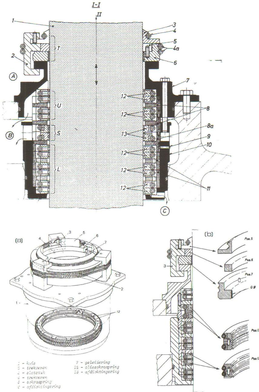
Elle va diviser l'espace de balayage entre le piston et le carter afin que les gaz de combustion ne puissent pas souiller l'huile de graissage.
